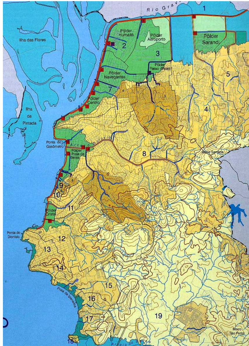
Figura 6.10 Cidade de Porto Alegre junto ao delta do Jacuí e Lago Guaíba. O escoamento das áreas verdes é bombeado para o Guaíba quando o dique protege contra inundações. As áreas marrons escoam por gravidade e escoamento sob-pressão.
