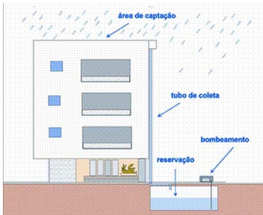
Figura 3.27 Reservatório em edifício (Canpana, 2004).
